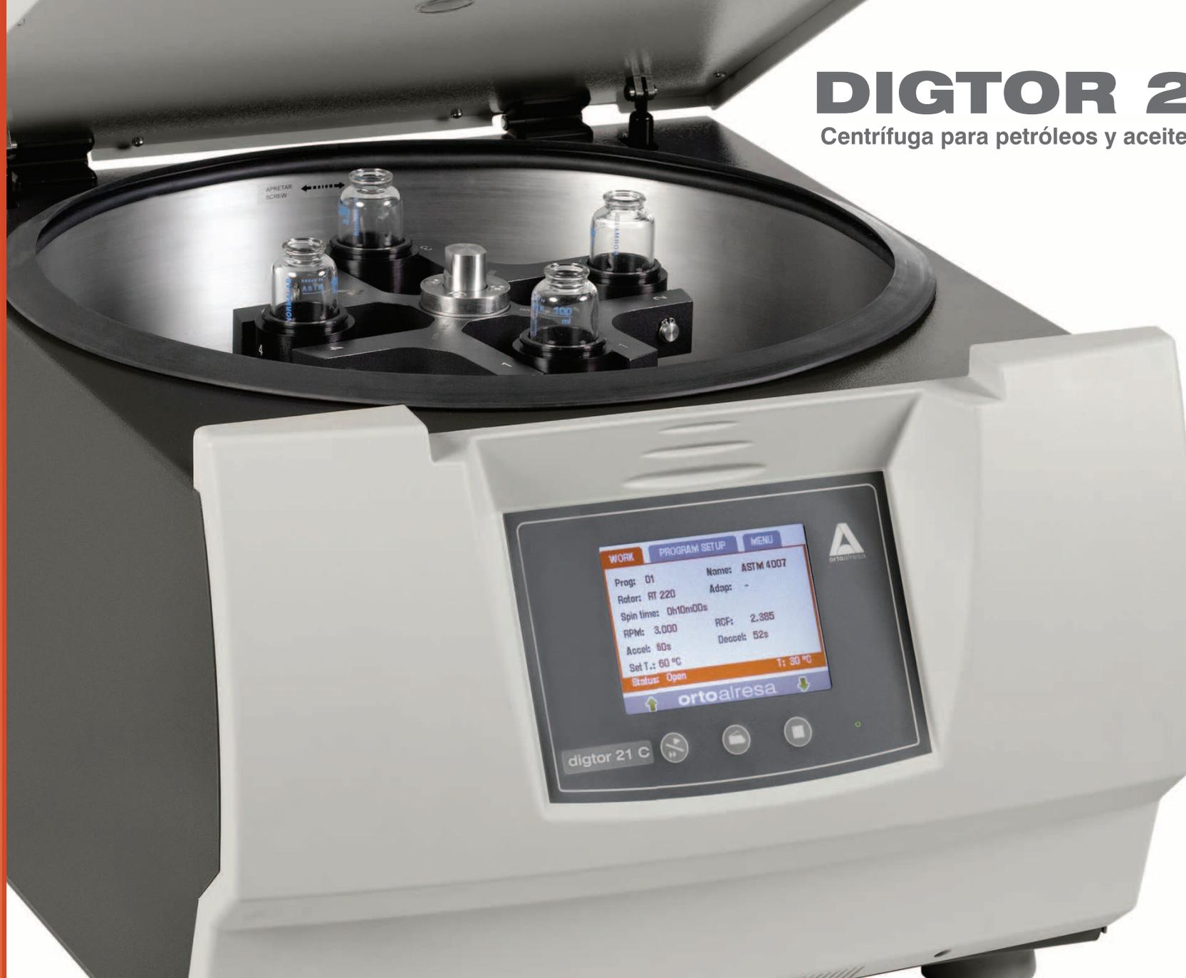
La centrífuga **Digtor 21 C** esta especialmente diseñada para la determinación de agua y sedimentos en petróleos, y características precipitación y demulsibilidad y caracterización de aceites usados.
