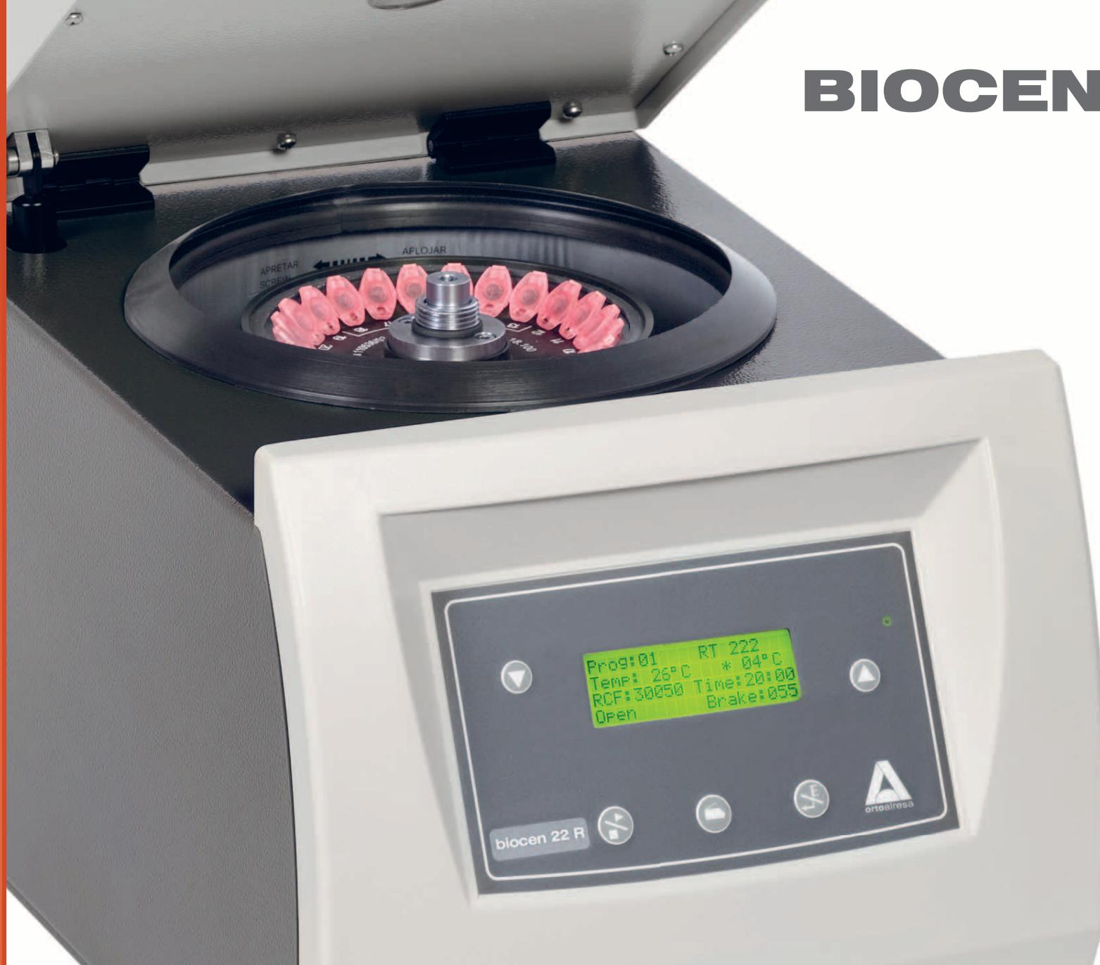
La microcentrífuga refrigerada **Biocen 22 R** destaca por alcanzar 30.034 x g, siendo una herramienta indispensable en los laboratorios más exigentes puede procesar hasta 24 microtubos de 2,2 ml, 32 de 0,2 ml y 8 x 15 ml cónicos.
